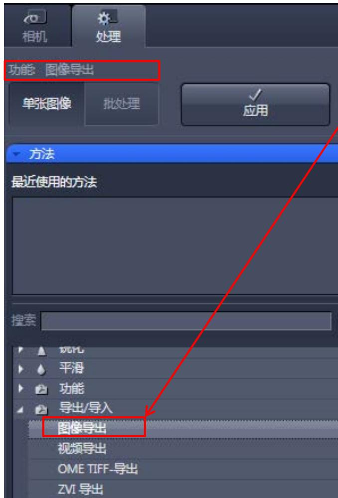
如需将原始图片导出成TIF或JPEG图片，可以在“处理”主页面的“单张图像”>>“方法”工具栏选择“导出/导入”菜单下的“图像导出”。选中该选项后，该方法名称将出现在“单张图像”按钮的上方。
