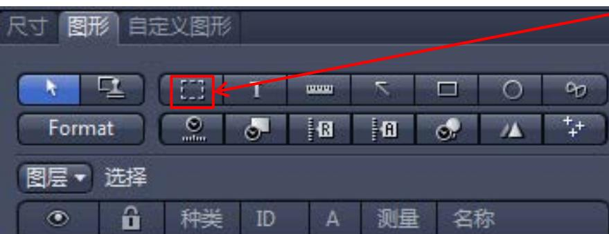
感兴趣区域ROI选择按钮。点击此按钮，在图像中用红色虚线方框框选感兴趣区域，使用Ctrl+Shift+C按钮，可将方框中的图像剪贴成一张新的图片。
