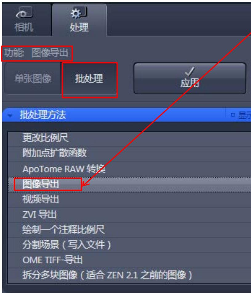
如需将多张原始图片导出成TIF或JPEG图片，可以在“处理”主页面的“批处理”工具栏选择“图像导出”。选中该选项后，该方法名称将出现在“批处理”按钮的上方。
