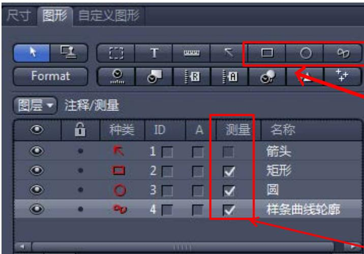
在图像下方的“图形”工具栏中，选择方框，圆形，不规则形状等常用测量工具。从左至右，依次为方框，圆形和不规则形状的添加按钮。
