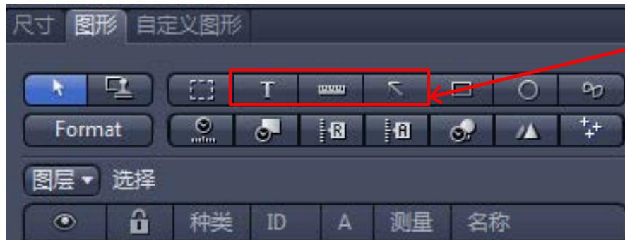
从左至右，依次为文本框，比例尺，箭头和方框的添加按钮。在图像上选中添加好的标注点击右键，选择“编辑标注项”Format，可以更改线条颜色，字体大小等注释格式。
