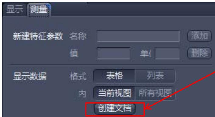
点击“测量”图像显示界面下方“测量”工具栏中的“创建文档”按钮。软件将测量结果生成一个新的图表文件。在菜单栏“文件”菜单中，选择“保存”，在“保存”对话框中选择保存文件格式.xml或.csv，可将此图表文件保存为Excel文件。
